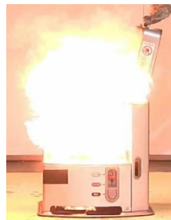
(写真) 消火後間もない高温の燃焼筒に灯油がかかり引火 (イメージ)
