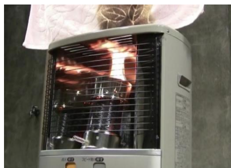
燃焼筒のずれによる異常燃焼
