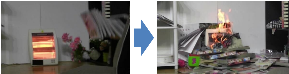
地震時に可燃物が飛散し、近くにあった電気ストーブに接触して発火
