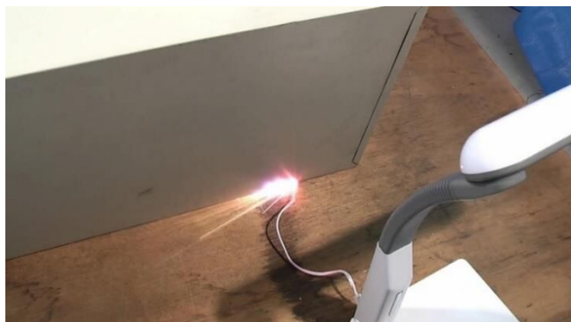
転倒したロッカーが電源コードを破損して発火
