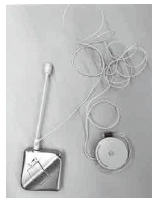
本庁舎1階窓口の集音器
